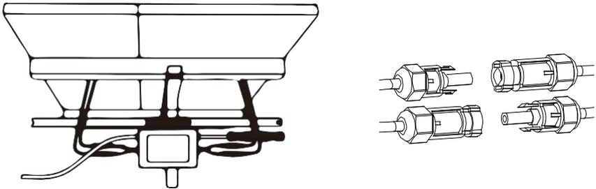
**HINWEIS:** Beim Einstecken der Gleichstromkabel sollte der Mikrowechselrichter, wenn bereits **Wechselstrom** vorhanden ist, sofort rot blinken und innerhalb der eingestellten Zeit (Standard 60 Sekunden) mit der Arbeit beginnen. Wenn kein Wechselstrom verfügbar ist, blinkt das rote Licht dreimal schnell und wiederholt sich nach einer Sekunde, bis AC angeschlossen ist.
