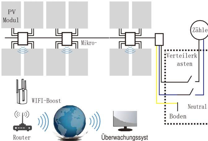
**HINWEIS:** Wenn das drahtlose Signal in dem Bereich, in dem der Mikrowechselrichter schwach ist, schwach ist, ist es notwendig, einen WiFi-Signalverstärker an einer geeigneten Stelle zwischen dem Router und dem Mikrowechselrichter hinzuzufügen.
