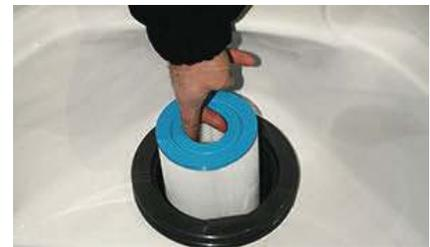
**Schritt 3.** Tauschen Sie den Filter. Es ist sinnvoll, herausnehmen können einen Lappen o.ä. zur Hand zu haben, um den evtl. austretenden Schmutz aufzufangen, bevor er ins Wasser gelangt.
